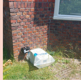
Voorbeelden van trillingsmeters. Deze worden mogelijk nog vervangen voor een kleinere accu.
