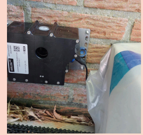
Voorbeelden van trillingsmeters. Deze worden mogelijk nog vervangen voor een kleinere accu.
